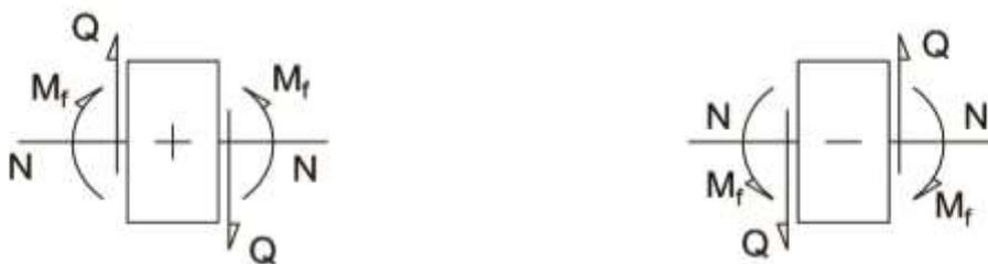
El esfuerzo normal será positivo cuando se trate de un esfuerzo de tracción. El esfuerzo de corte será positivo, cuando tenga un sentido horario de rotación respecto de un punto interior del cuerpo libre. El momento flector será positivo cuando produzca la tracción de las fibras inferiores y la compresión de las fibras superiores.
